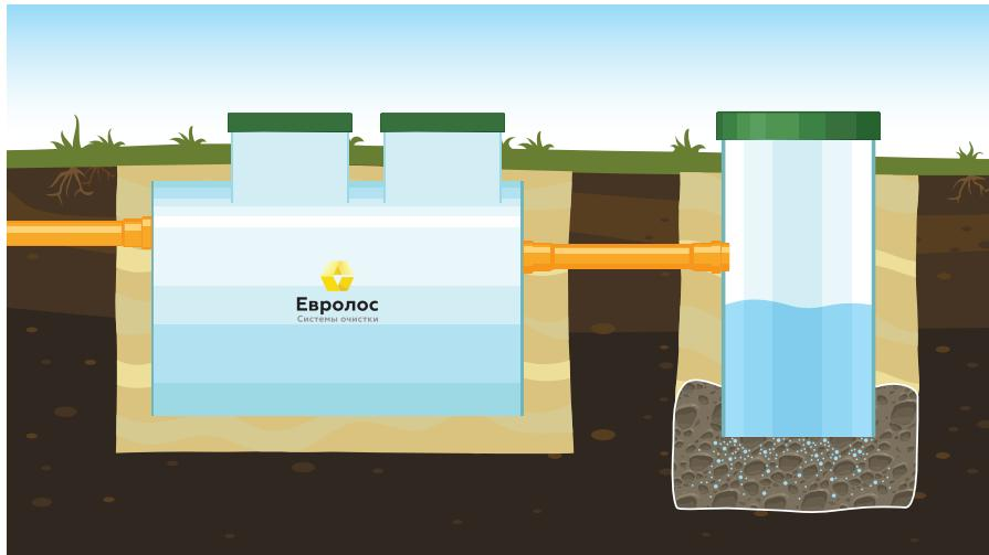
**Вариант 3:** Монтаж с отводом очищенной воды в фильтрующий колодец. Подходит для хорошо поглощающих грунтов (песок, супесь) и низком уровне грунтовых вод.
