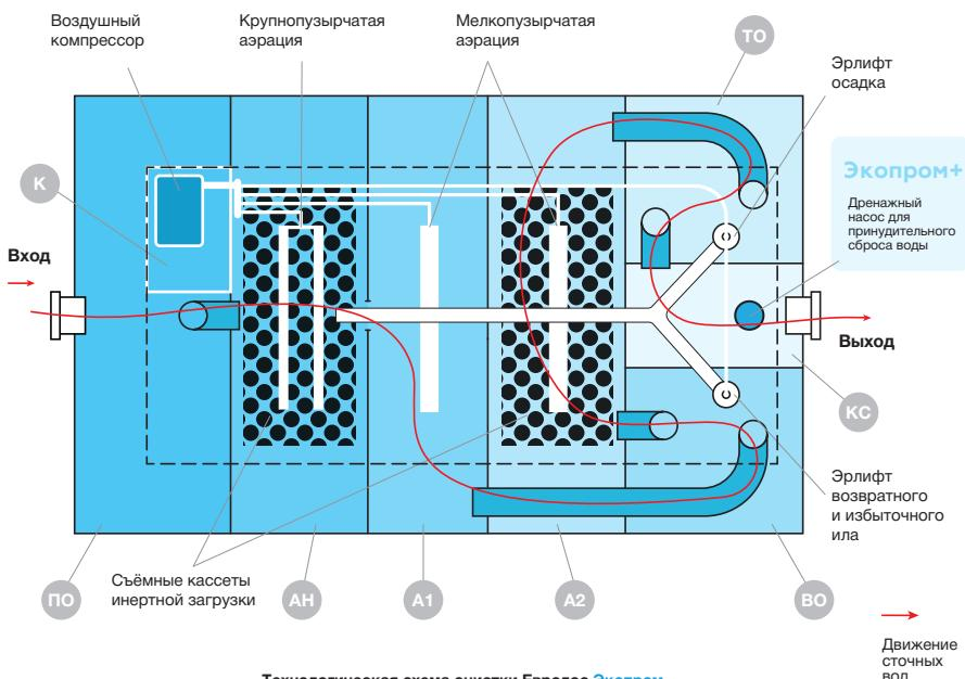
1. Сточная вода от канализуемого объекта поступает в первую секцию сооружений **ПО**, которая представляет собой анаэробную камеру для задержания основной массы органических загрязняющих веществ. Также в этой камере происходит разложение задержанного органического осадка.
