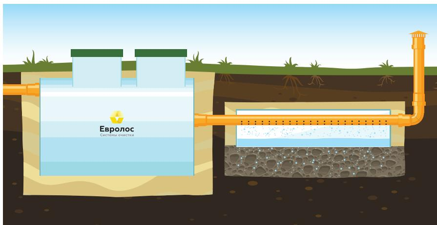
**Вариант 4:** Монтаж с отводом очищенной воды в дренажный элемент. Подходит для хорошо впитывающих грунтов (песок, супесь) и низком уровне грунтовых вод.
